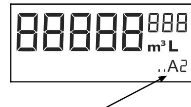
Цифра после 'A' означает количество регулировок, которым был подвергнут счетчик. В новом счетчике эти два знака светиться не должны.
