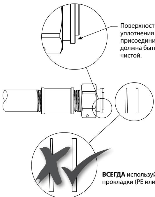
Соединение с трубой должно быть без перекоса и соответствовать размеру счетчика.
