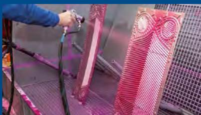
Готовые теплообменники thermowave проходят испытания (цветная дефектоскопия согласно стандартам DIN EN ISO 3452 и DIN 54152), испытание давлением, вакуумное испытание модулей. Имеются сертификаты специализированных организаций.
