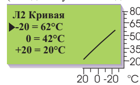
в) Начальное регулирование сети кондиционирования (заводская установка для сети L2)
