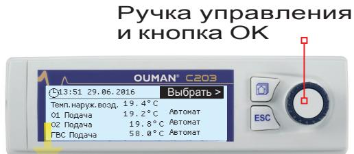
Перейдите в раздел «Сервисный режим» с помощью поворотного колёсика и нажмите клавишу OK.
